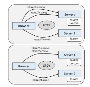
Fig. 6. Connection Reuse in SPDY
